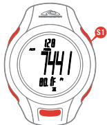
ECRAN 3 Ligne supérieure: RYTHME D'ASCENSION OU DE DESCENTE PAR MINUTE INDIQUE EN PIEDS OU EN METRES Ligne centrale: ALTIMÈTRE COURANTE Ligne inférieure: TEMPÉRATURE
