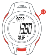
ECRAN 1 Ligne supérieure: HEURE DU JOUR Ligne centrale: ALTIMÈTRE COURANTE Ligne inférieure: TEMPÉRATURE
