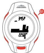
ECRAN 2 Ligne supérieure: HEURE DU JOUR Ligne centrale: GRAPHIQUE INDIQUANT LES CHANGEMENTS D'ALTIMÈTRE SUR UN LAPSE DE TEMPS Ligne inférieure: ALTIMÈTRE COURANTE
