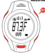
PANTALLA 4 Línea Superior: PRESIÓN BAROMÉTRICA MSL Center Line: TEMPERATURA Bottom Line: PRESIÓN BAROMÉTRICA LOCAL SIN AJUSTAR
