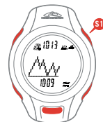
PANTALLA 2 Línea Superior: PRESIÓN BAROMÉTRICA MSL Línea Central: GRÁFICO DE LA PRESIÓN BAROMÉTRICA DURANTE LAS ÚLTIMAS 24 HORAS Línea Inferior: PRESIÓN BAROMÉTRICA LOCAL SIN AJUSTAR
