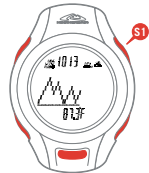
PANTALLA 3 Línea Superior: PRESIÓN BAROMÉTRICA MSL Línea Central: GRÁFICO DE LA PRESIÓN BAROMÉTRICA DURANTE LAS ÚLTIMAS 24 HORAS Línea Inferior: TEMPERATURA
