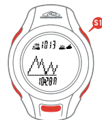
PANTALLA 1 Línea Superior: PRESIÓN BAROMÉTRICA MSL Línea Central: GRÁFICO DE LA PRESIÓN BAROMÉTRICA DURANTE LAS ÚLTIMAS 24 HORAS Línea Inferior: HORA DEL DÍA
